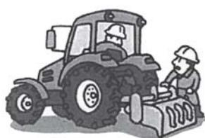
トラクターに装着する作業機にはプラウのようにはん引する物と、ロータリーのようにつなぎする物があります。最近は、オートヒッチを使うことによって、トラクターとの着脱が簡単に行えるようになっています。しかし、トルクターハイドロの出力・けん引力と作業機の所要動力が適正な組み合わせでないと、トラブルにつながってきます。オートヒッチが開発される前は、ロワーリンク、トップリンク、PTOの順に接続をしていましたが、機械の大型化や重量化に伴い、挟まれ、作業機の転倒などによる事故が増えてきました。これによつて、着脱は簡単に見えるようになりますが、作業機が不安定したが、作業機が不安定
