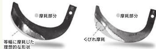
爪が磨耗すると…細土性や反転性の「耕うん性能」が低下します。また、耕す力の弱い爪で無理に作業をすると「機械への負担」が増えます。さらに、磨耗した爪はトラクターを前に押し出す力も弱くなり、「燃費」も悪くなります。
