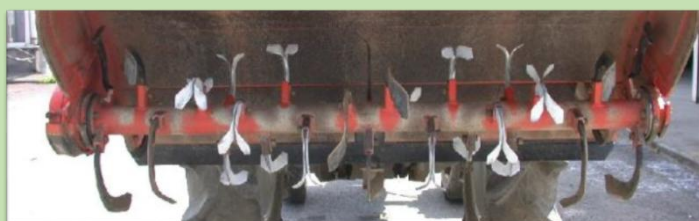
↑ 図2 部分浅耕の爪の付け替え例
